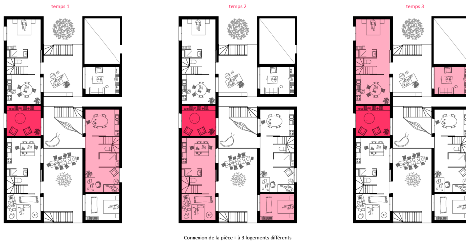
Fig. 24 : plans de 3 logements, variation de l'appropriation et de l'association de la pièce en plus
