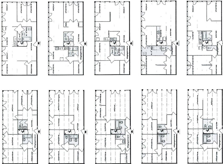
Fig. 12 : en haut, cinq exemples de plans proposés par les architectes, en bas cinq exemples de plans proposés par les habitants
