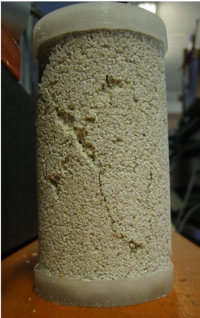
Eprouvette fissurée après l'essai mécanique
