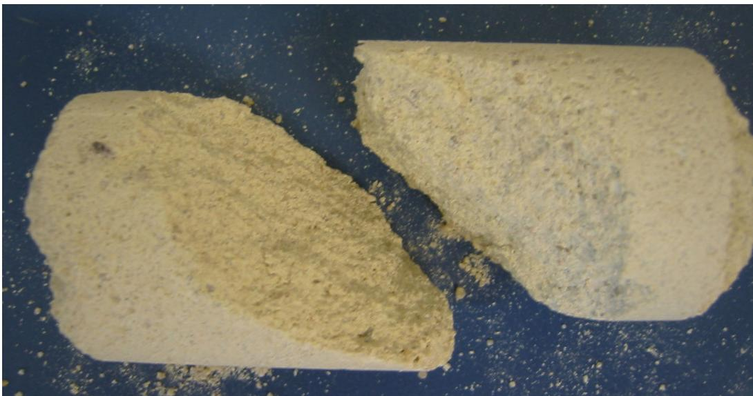
Rupture en bande de cisaillement d'une éprouvette
