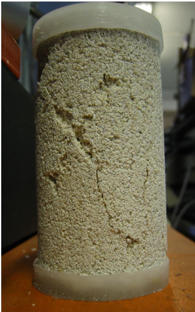
Eprouvette fissurée après l'essai mécanique
