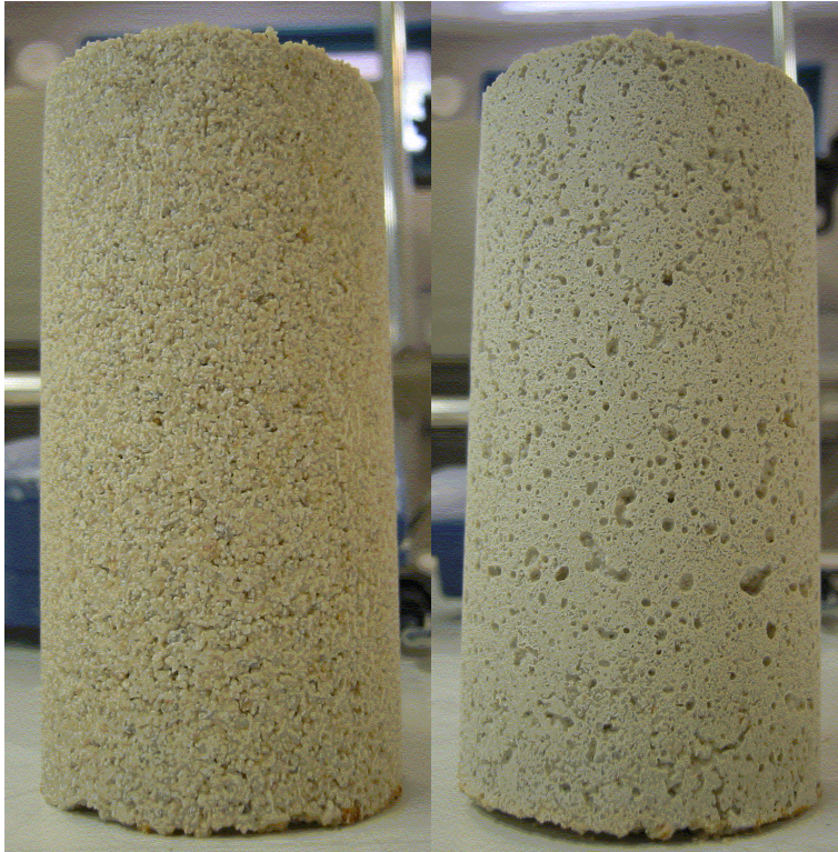
Éprouvette à 5% d'argile et peu d'eau et éprouvette à 25% d'argile et beaucoup d'eau
