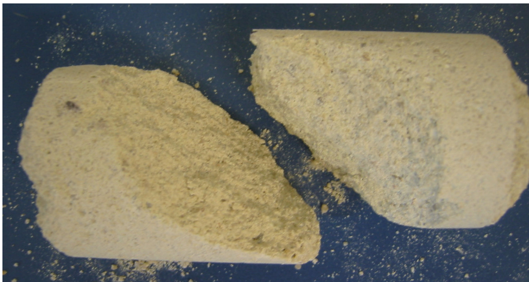
Rupture en bande de cisaillement d'une éprouvette
