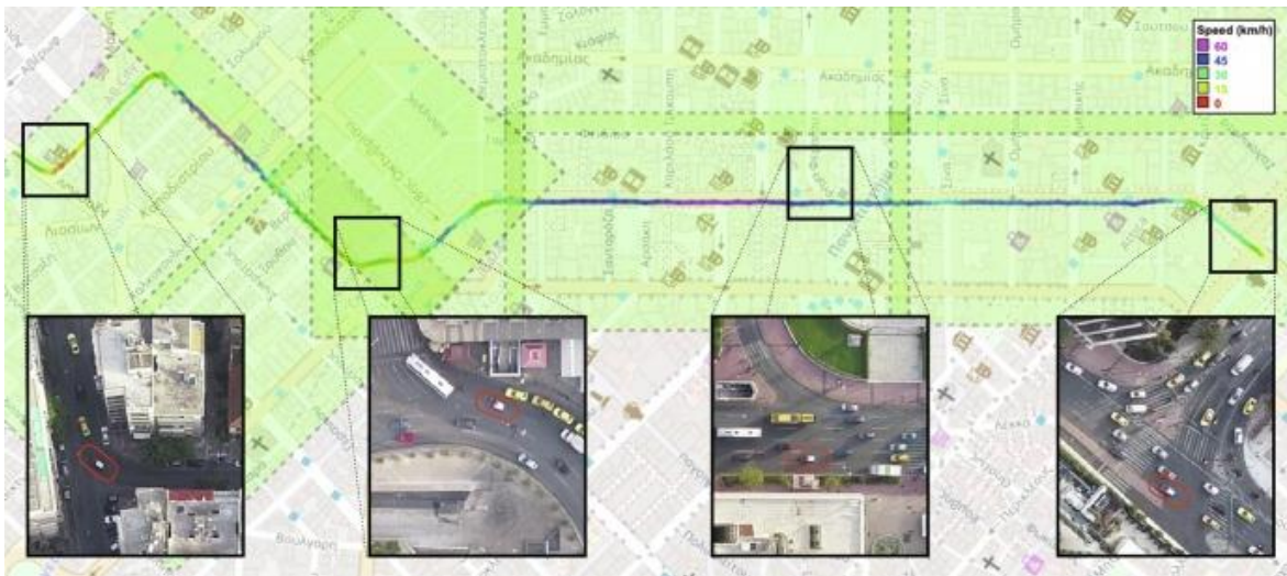
Figure 16 - Illustration du suivi d'un véhicule par plusieurs drones. Source : (Barmounakis and Geroliminis, 2020).
