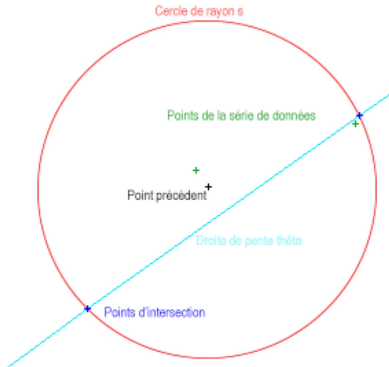
Figure 32 - Illustration de la représentation géométrique utilisée pour déterminer les coordonnées des points en connaissant \tilde{s} .
