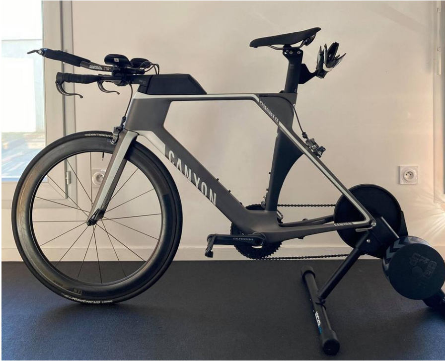
Figure 3. Installation d'un vélo sur home-trainer connecté type KICKR core.
