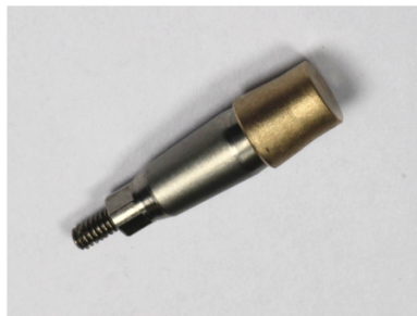
Figure 25 : Pilier titane usiné et chape en or électrodéposé 4
