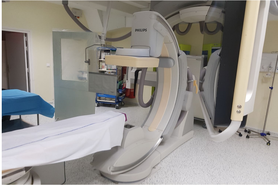
Arceau avec amplificateur de brillance en radiologie interventionnelle au CHU de Rouen.
