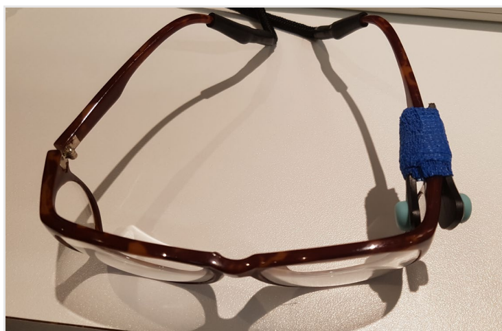
Lunettes plombées avec deux dosimètres DOSIRIS fixés : un intérieur et un extérieur sur la branche gauche.
