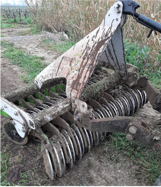
Figure 7 : Outils de destruction du couvert sans travail du sol (source CICOVI)
