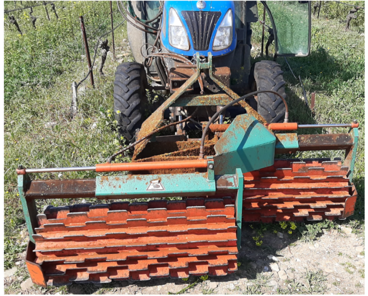
Figure 7 : Outils de destruction du couvert sans travail du sol (source CICOVI)
