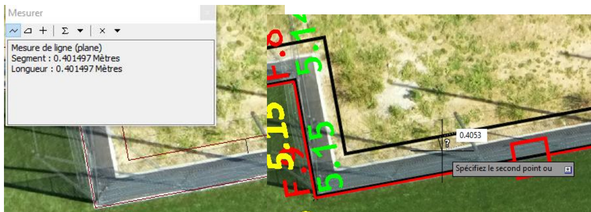
Figure 25 : Visualisation de l'écart entre l'orthoimage et le plan de récolement dans AutoCAD MAP 3D et dans ArcMAP.
