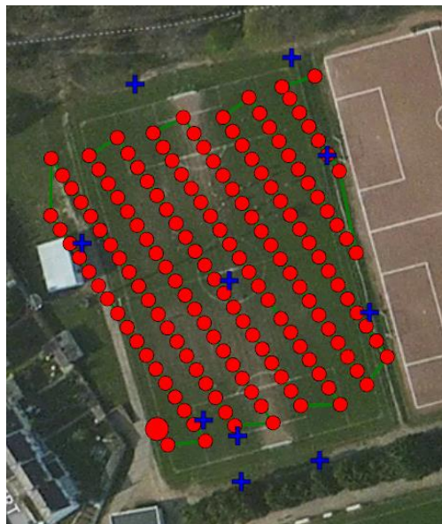
Figure 21 : Visualisation des positions des prises de vues avec le drone ANAFI sur Pix4D Mapper
