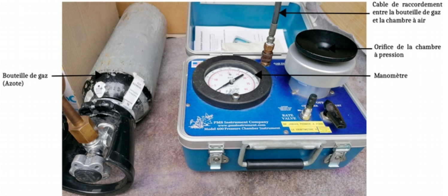
Figure 20: Montage de la chambre à pression pour les mesures de potentiel hydrique de tige (source : Lucie Laville)
