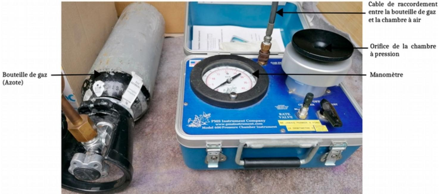
Figure 20: Montage de la chambre à pression pour les mesures de potentiel hydrique de tige (source : Lucie Laville)
