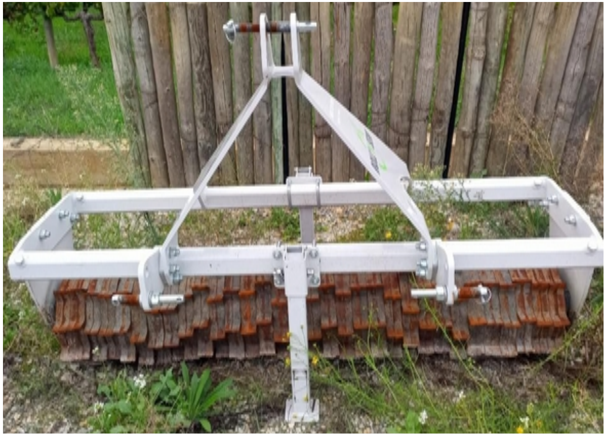
Figure 15: Rolofacat Roll' n'Sem® de Comin Industrie (source : Lucie Laville)
