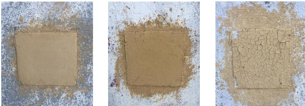
Fig. 91 : expérimentation des trois types de mélange pour réaliser la première couche d'enduit terre sur les poteaux :
