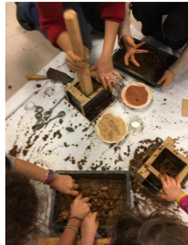
Fig. 117 : compacter la terre humide dans le coffrage, chasser l'air. (©M. MAHDIEH, 2019)
