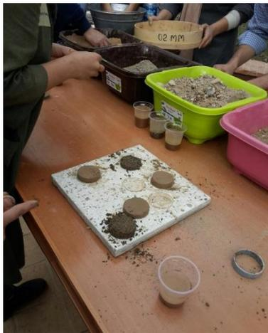
Fig. 34: test de la Pastille. (©M. HOSSEINI, 2018)
