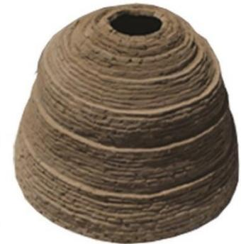
Fig. 84 : fabrication de la petite maquette d'un dôme de glacière à l'échelle 1/20. (©M. MAHDIEH,2012)
