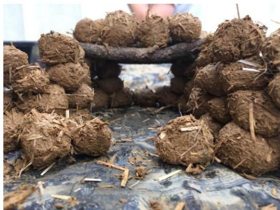
*Fig. 103 : Construction en technique bauge.
