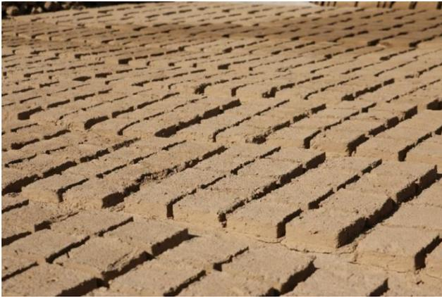
Fig. 65 : fabriquer des adobes. (©V. EBRAHIMZADEH, 2018)
