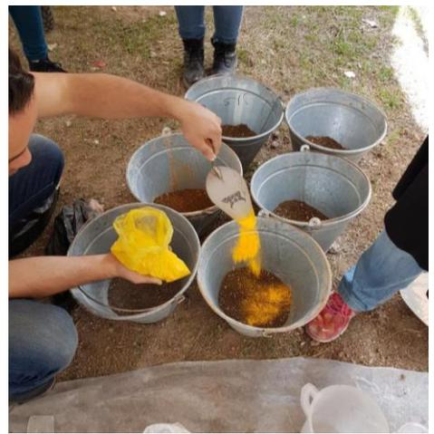
Fig. 37 : essais de petits échantillons de diverses couleurs. (©M. MAHDIEH, 2018)
