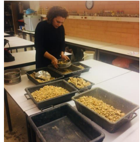
Fig. 130 : préparation d'atelier, tamisage la terre. (©S. OMIDVARI, 2018)
