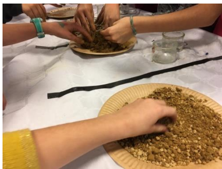
Fig. 113 : connaître les 5 états hydriques (sec, humide, plastique, visqueux, liquide) et savoir que l'état visqueux est le mieux adapté pour cette technique. (©M. MAHDIEH, 2019)
