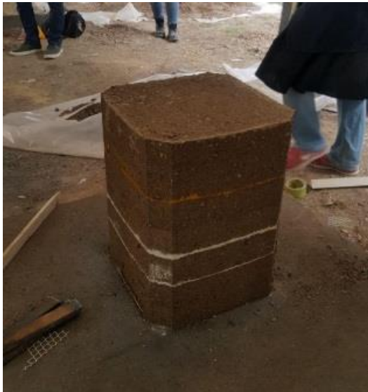
Fig. 38: réalisation d'un pisé. (©M. KHOSRAVI, 2018)
