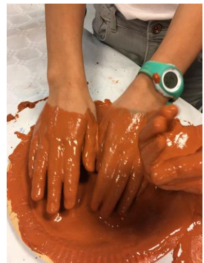
Fig. 113 : connaître les 5 états hydriques (sec, humide, plastique, visqueux, liquide) et savoir que l'état visqueux est le mieux adapté pour cette technique. (©M. MAHDIEH, 2019)
