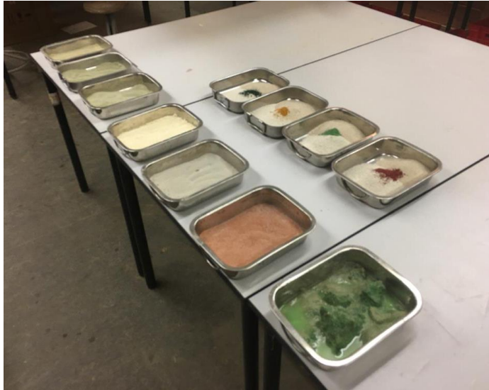
Fig. 100 : préparation des différents mélanges pour réaliser les boules de différentes couleurs au laboratoire CRAterre : terre blanche de Paris + sable tamisé 2 mm + pigments naturels / l'argile colorée + sable fin/ la terre rouge sableuse. (©M. MAHDIEH, 2020)
