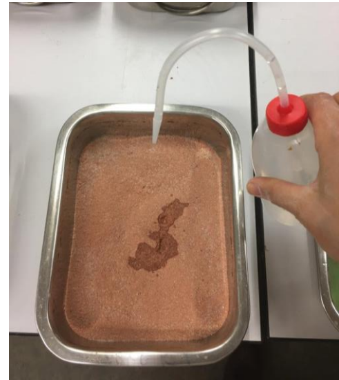
Fig. 100 : préparation des différents mélanges pour réaliser les boules de différentes couleurs au laboratoire CRAterre : terre blanche de Paris + sable tamisé 2 mm + pigments naturels / l'argile colorée + sable fin/ la terre rouge sableuse. (©M. MAHDIEH, 2020)
