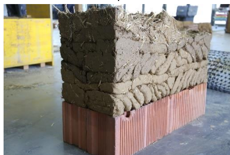
Fig. 139 : construction en bauge.(image :1,2,3,4,5,6 :©M. POINTET & image :7,8 : © M. MAHDIEH, 2018)
