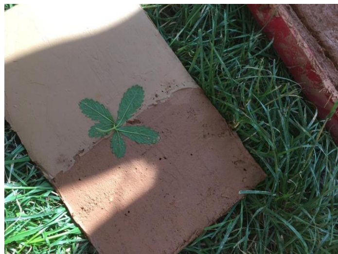
Fig. 88 : utilisation des feuilles pour donner la texture finale sur la couche finition. (©M. MAHDIEH, 2019)
