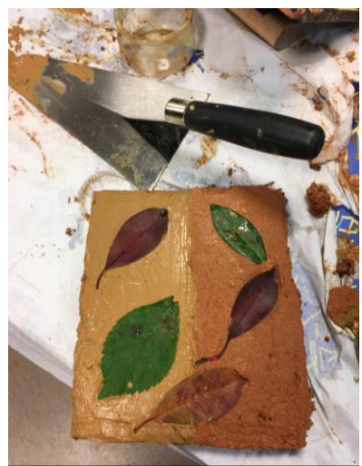
Fig. 89 : réalisation d'un enduit terre sur un petit morceau plat en bois. (©M. MAHDIEH, 2019)
