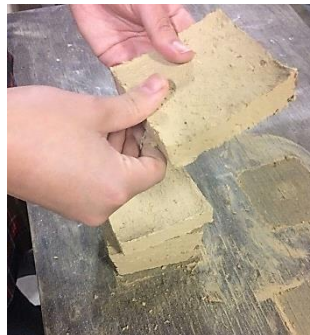
Fig. 132 : essai adobe afin de choisir le meilleur mélange de la terre. (©S. OMIDVARI, 2018)
