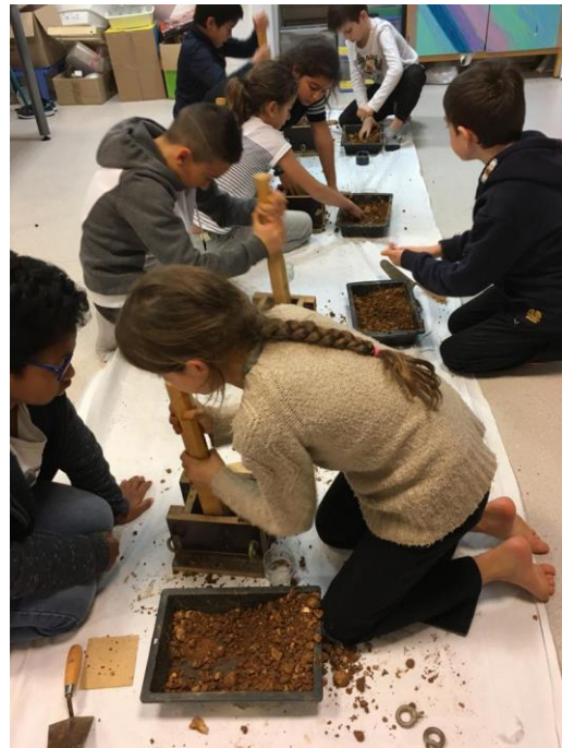
Fig. 119 : exécution d'un cube pisé décoratif. (©M. MAHDIEH, 2019)
