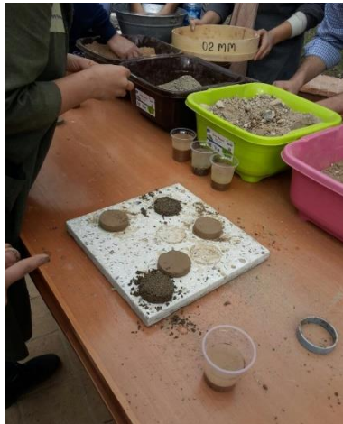
Fig. 34: test de la Pastille. (©M. HOSSEINI, 2018)
