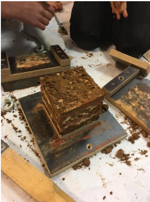
Fig. 119 : exécution d'un cube pisé décoratif. (©M. MAHDIEH, 2019)
