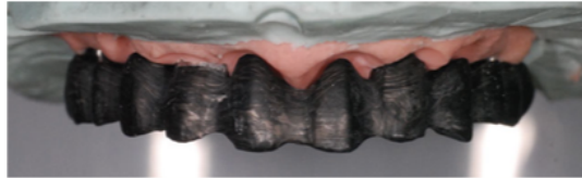
Fig. 5.7 : Armature de prothèse complète implanto-portée maxillaire en composite renforcé aux fibres de carbone (207)
