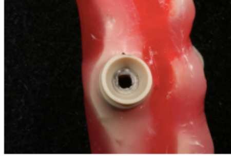
Fig. 5.4 : Strangulation du PEEK au niveau du cylindre due à la compression de la vis prothétique en titane après serrage (185)
