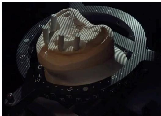
*Fig. 4.27 : Scannage du modèle (162)*
