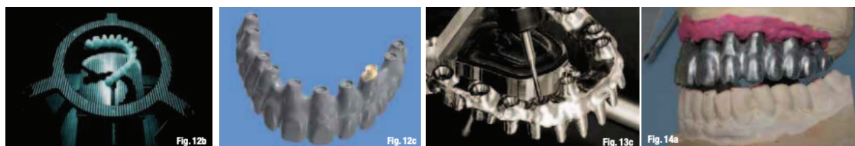
Fig. 4.22 : Scannage, modélisation, usinage et essai de la pièce prothétique (159)
