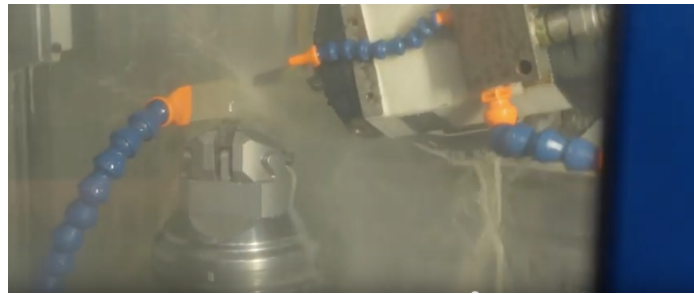
Fig. 4.30 : Usinage d'une armature au sein du groupe Dentsply (162)
