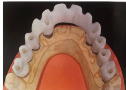
Fig. 4.3 : Armature en zircone après usinage (148)
