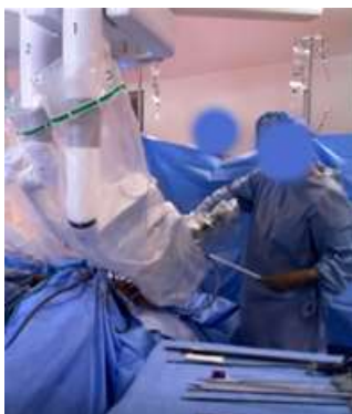
Figure 11 : Exemple du bras 1 du robot venant heurter le bras de l'aide-opérateur travaillant sur le trocart de 5/12
