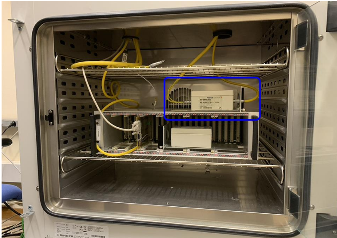
FIG. 11 — Chambre thermique dans laquelle est placé le conditionneur testé (encadré en bleu)
