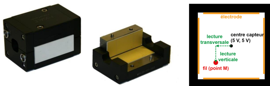
FIG. 3 — À gauche, capteur WPS Fogale Nanotech fermé. Au centre, partie inférieure du capteur ouvert où l'on distingue les deux électrodes de couleur or. À droite, vue schématique en coupe d'un capteur.
