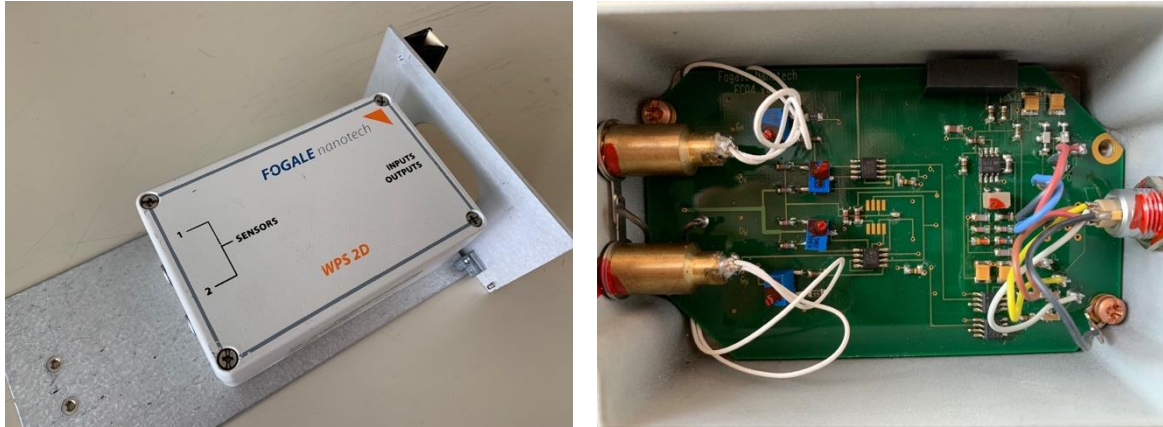
FIG. 4 — Conditionneur de marque Fogale Nanotech. Le circuit électronique est placé dans un boîtier hermétique. Le capteur est relié par une paire de câbles et le conditionneur est relié au système d’acquisition par un unique câble.
