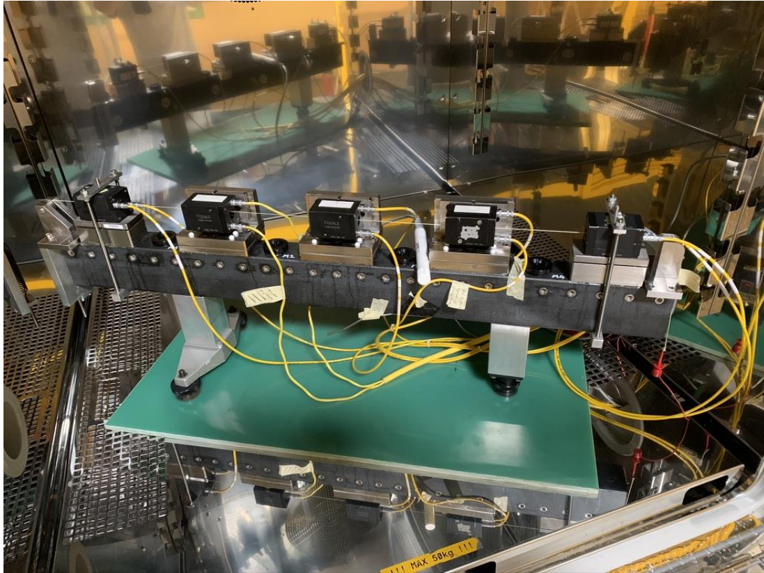
FIG. 26 — Banc équipé des capteurs dans la chambre climatique
