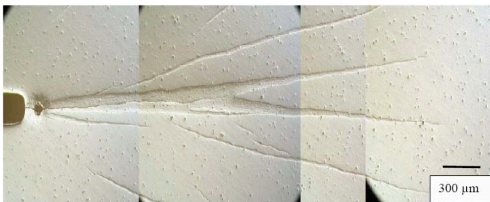
Figure 22 : renforcement par transformation de phase (41)
