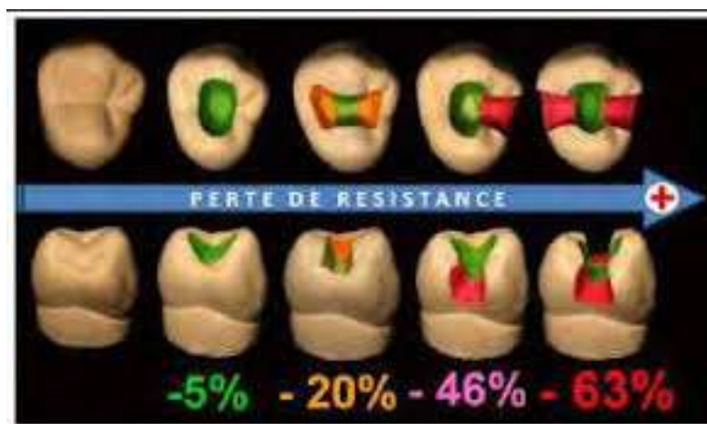
Figure 7 : Perte de résistance en fonction de la perte de substance
