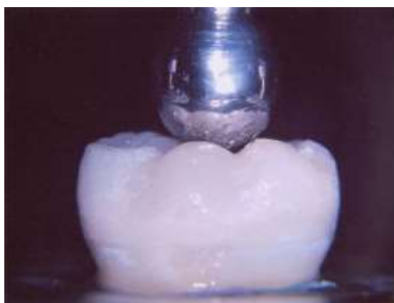
Figure 11 : Force axiale directement appliquée sur la restauration
