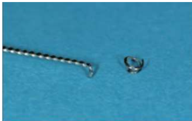
Figure 43 : Lime endodontique courbée et filetage de la vis retiré d'un implant
