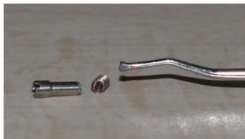
Figure 42 : Rainure réalisée sur le fragment de vis et excavateur modifié
