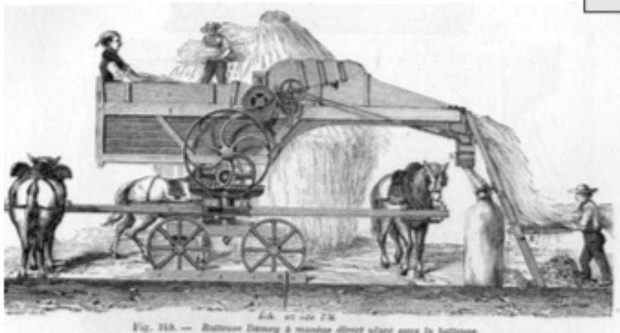
Fig. 249. — Batteuse Daimy à manège direct piloté avec la batteuse.
