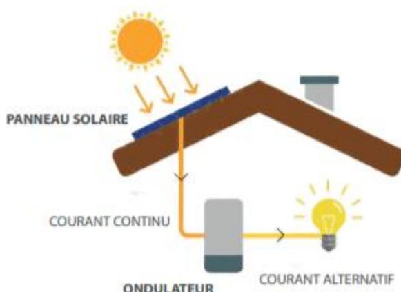
**Figure 40 : Panneaux photovoltaïques**
