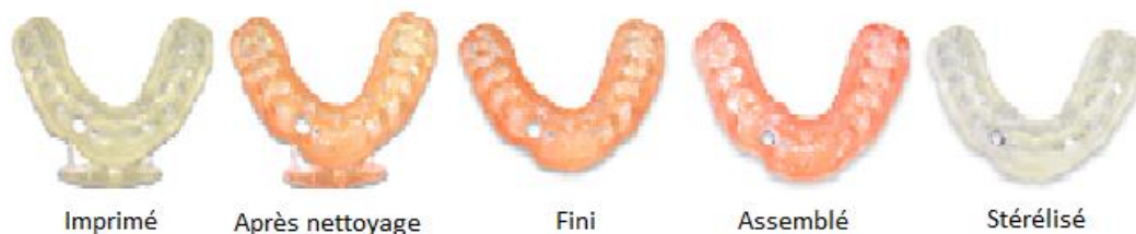
Figure 21: Changements de couleur d'un guide chirurgical pendant le protocole de traitement après impression
