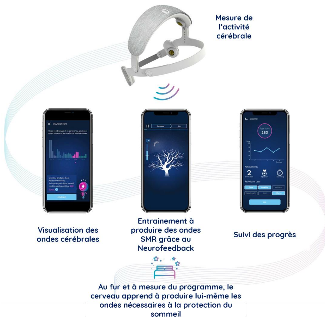
Figure 7 : Fonctionnement du Bandeau URGOnight (Source : URGO)
