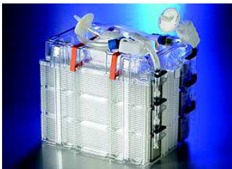
Figure 48 : à gauche, un Hyperstack à 36 étages ; à droite, le bioréacteur iCELLis® (191)
