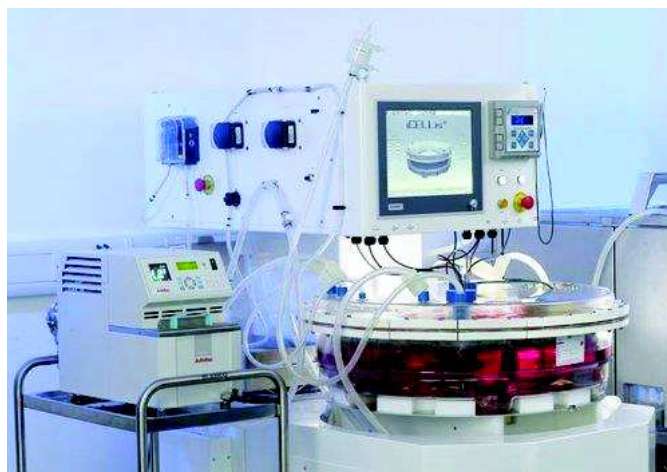
Figure 48 : à gauche, un Hyperstack à 36 étages ; à droite, le bioréacteur iCELLis® (191)
