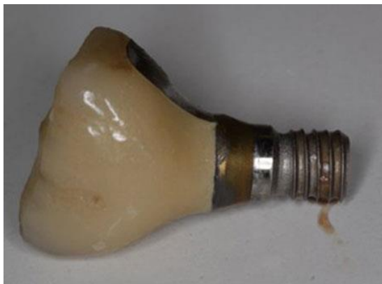
Figure 17 : Photographie d'un implant ayant fracturé au niveau du corps.
