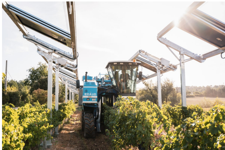
Illustration 24 Système développé par Ombrea au dessus d'un vignoble (Source : Ombrea, https://www.pv-magazine.fr/2019/12/05/ombrea-des-synergies-entre-lagricole-et-le-photovoltaïque-sont-possibles-dans-certains-cas-de-figure/ )
