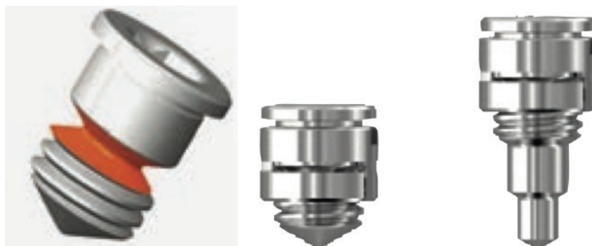
Image 19 : A gauche, un verrou de fixation Inlink®. En orange, la gorge de rupture destinée à jouer le rôle de fusible en cas de surcharge mécanique. Au centre un verrou standard et sa bague de maintien. A droite un verrou guidant et sa bague de maintien.
