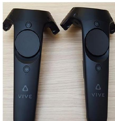
Figure 5 : Contrôleurs de mouvements des bras-
