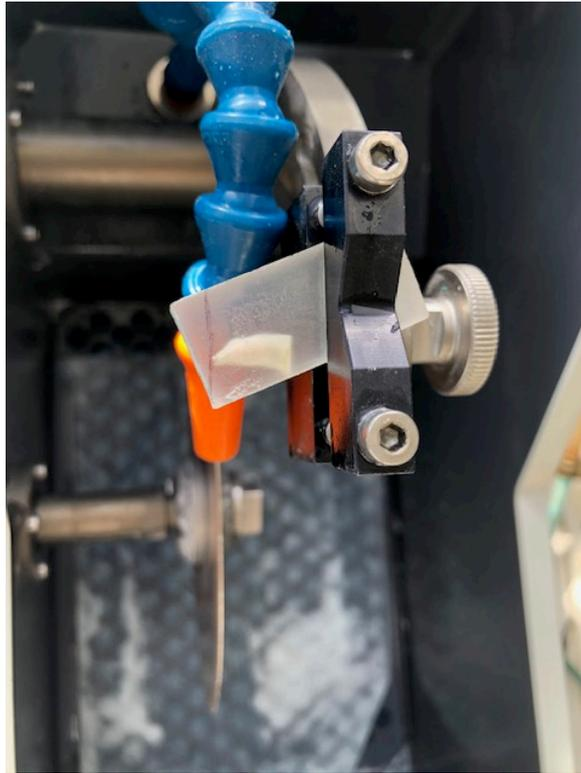
*Figure 41. Échantillon placé dans le microtome et positionné de façon à ce que les plaques noires entre lesquelles il est serré soient parallèles à l'axe de coupe.*
