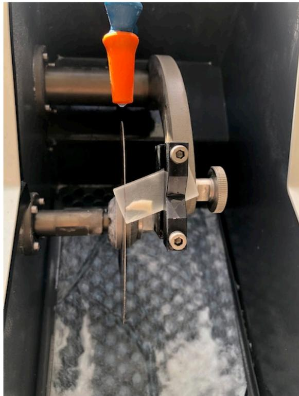
*Figure 42. L'échantillon est placé de façon à ce que l'apex anatomique soit sur l'axe du disque.*
