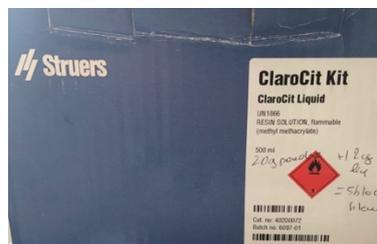
Figure 39. Résine utilisée pour l'inclusion des racines.
