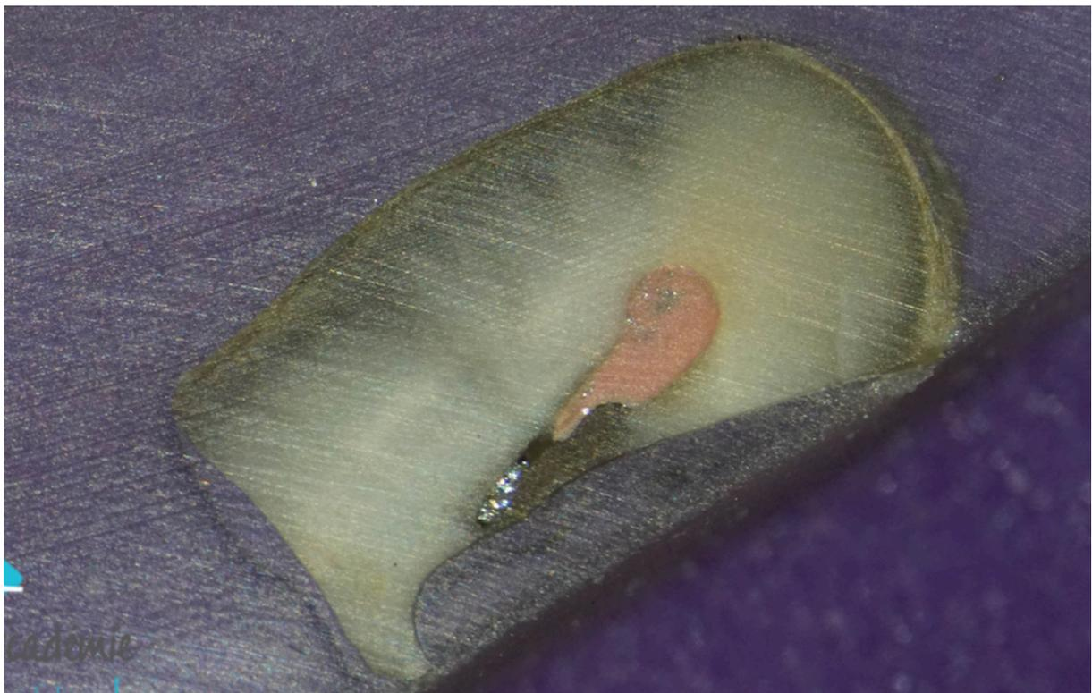
Figure 54. Manque d'obturation présent sur la coupe à 9 mm de l'échantillon n°313. On note parallèlement une déformation du cône.
