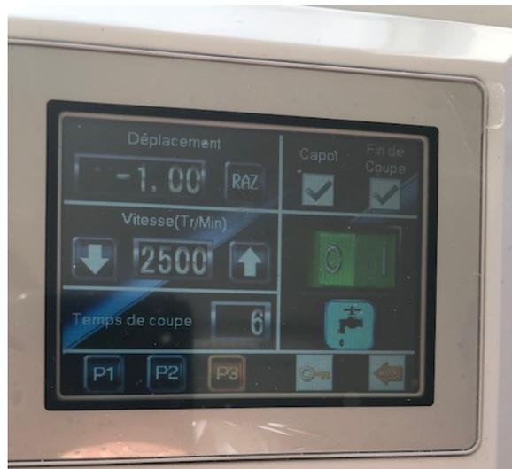
Figure 44. Écran du microtome montrant un déplacement de -1,0 mm par rapport à la position initiale de l'échantillon : ce déplacement correspond à la position de coupe à 1 mm de l'apex anatomique.
