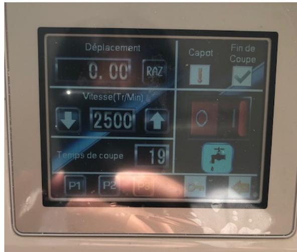
Figure 43. Ecran du microtome: dans la fenêtre déplacement, on peut choisir la valeur numérique du déplacement de l'échantillon par rapport au disque, et ainsi positionner les coupes à x distance en mm de l'apex anatomique.
