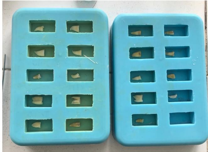
Figure 37. Positionnement des racines dans les moules à résine.
