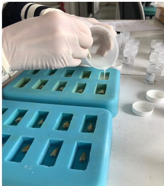
Figure 38. Remplissage des moules avec la résine, jusqu'à recouvrir complètement les racines.
