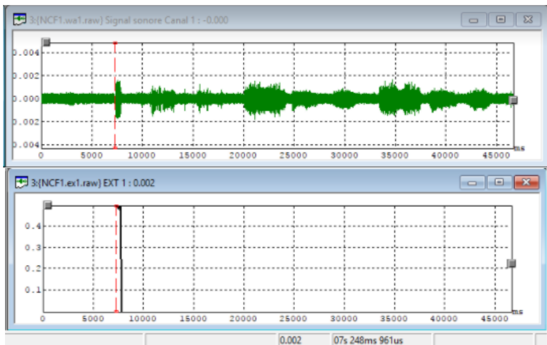
Illustrations du repérage du signal sonore servant à la synchronisation. Ici, le signal avait donc lieu à 7s et 248ms, comme nous l'indique l'emplacement en bas à droite de l'image.
