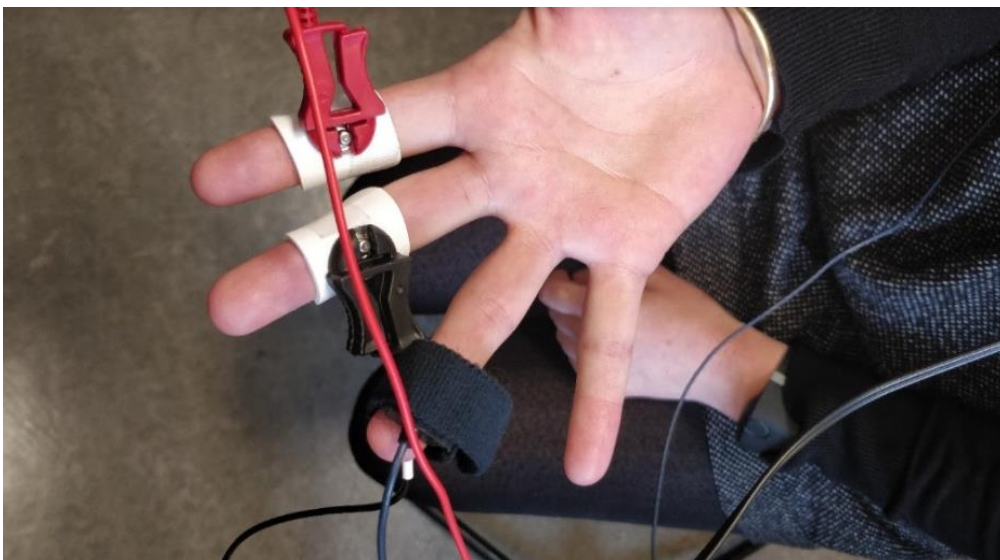
Présentation de l'installation des capteurs mesurant l'activité cardiaque ainsi que la réponse électrodermale
