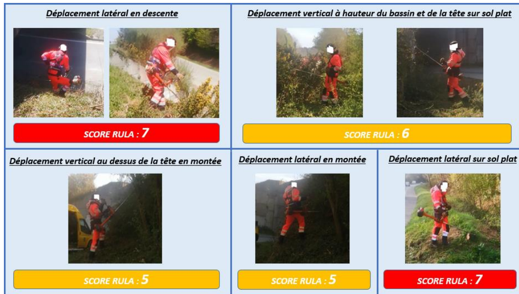
Figure 29 : Postures clés identifiées lors de l'activité de débroussaillage accompagnées de leur score RULA
