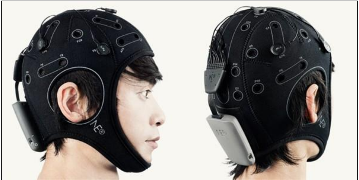
FIGURE 3 : Modèle Starstim dont les réglages et déclenchement sont transmises par Bluetooth.
