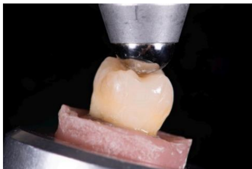
Figure 17 Machine d'essai universelle avec un angle de 15^\circ (40)
