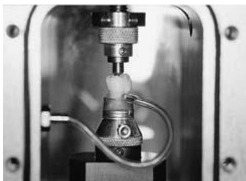
Figure 15 : Appareil de fatigue utilisé pour simuler les contraintes masticatoires cycliques et la pression pulpaire(35)
