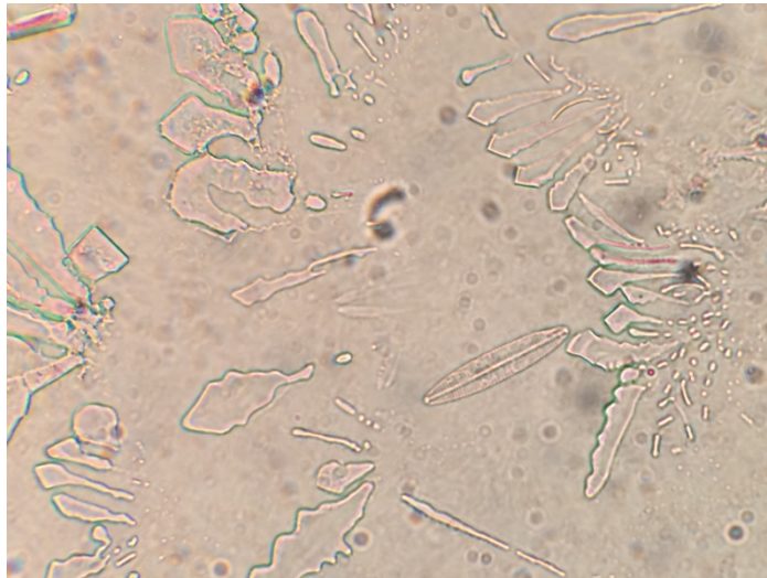
Figure 20: Cristaux de NaCl en plus faible proportion observés au microscope en objectif x40 sur lame T0 Diaphyse après ajout de HCl et décantation pendant 24h (source : Jennifer Bertin)
