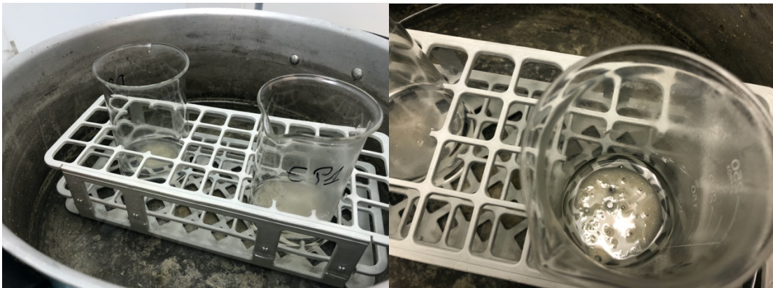
Figure 14: Étape du mélange prélèvement - l'eau oxygénée chauffée bain marie et présence de l'effervescence en cours au centre du bécher (source : Jennifer Bertin)
