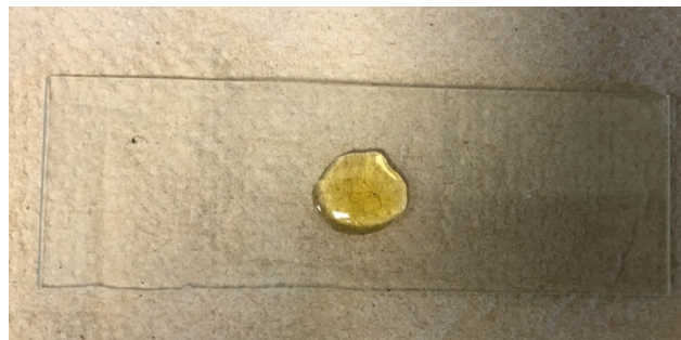
Figure 17: Naphrax (fixateur) déposé sur la lame de microscope (source : Jennifer Bertin)
