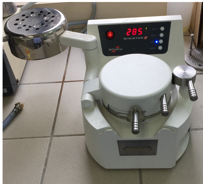
Figure 3 : Mise en forme de la plaque sur le modèle en plâtre et refroidissement
