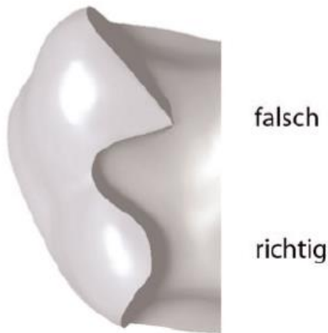
Figure 17: Forme de la cavité occlusale : les transitions nettes doivent être évitées (50).
