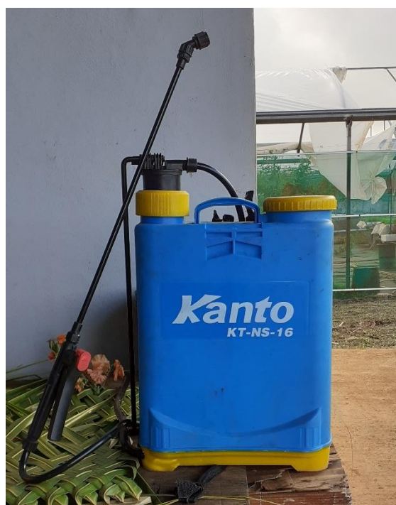
Figure 16 - Photo du pulvérisateur à dos 16L du fabricant Kanto. Source : Breuil
