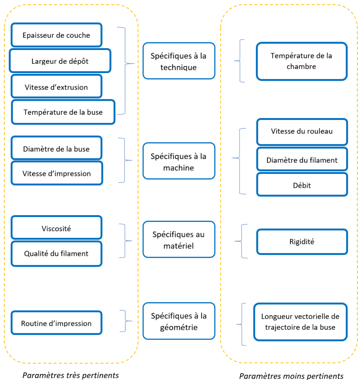
Figure 28: diagramme des paramètres ayant des effets sur les petites pièces PEEK en FDM (34)
