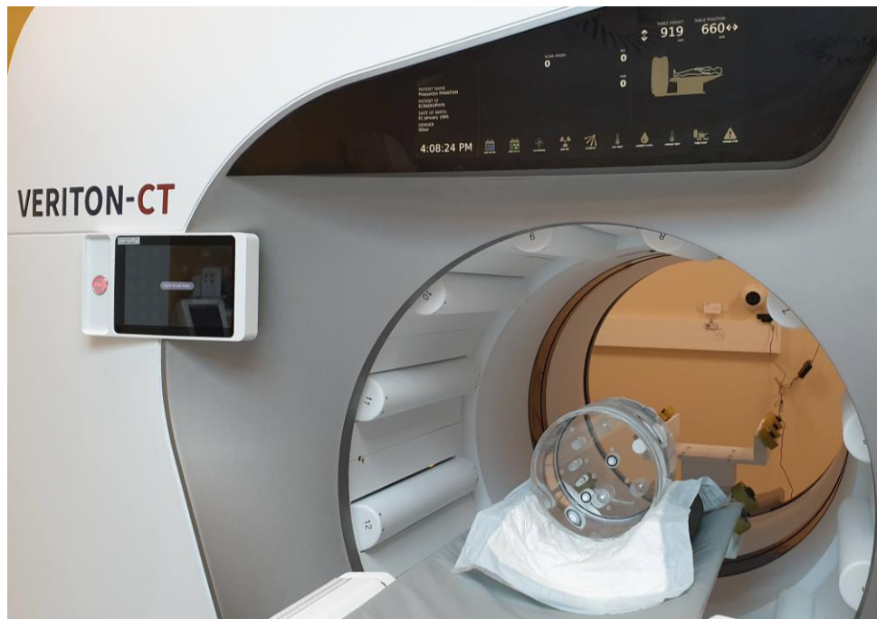
Figure 22 Positionnement du fantôme lors des acquisitions par la gamma-caméra Veriton-CT ®
