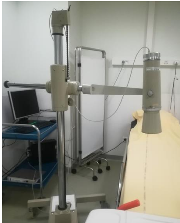
Figure 12 Sonde à scintillation utilisée dans notre étude
