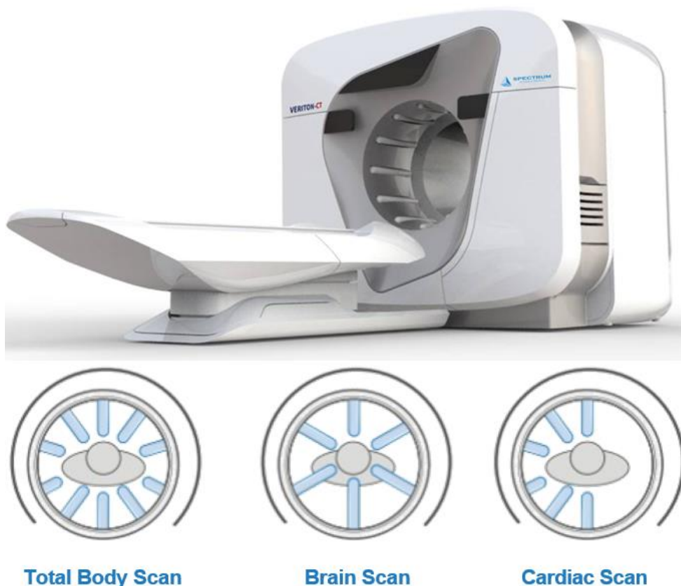
Figure 20 Représentation de la gamma-caméra Veriton-CT ® et du positionnement des détecteurs lors de différents examens (corps entier, cerveau et cœur) – Spectrum Dynamics Medical 2019 (54)
