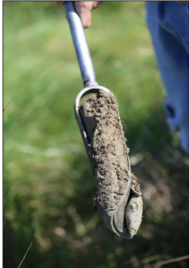
Figure 82 : Photographies de moi-même utilisant la tarière manuelle sur le terrain (S. Marie, Avril 2021)
