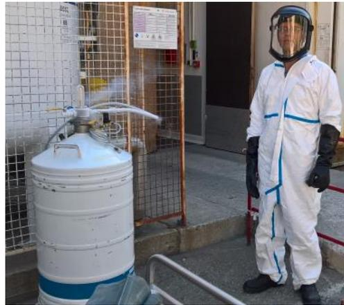
Un stockage à  $-80^{\circ}\text{C}$  d'une durée de 24 h est réalisé avant le transfert vers le stockage en cuve d'azote liquide pour les autres conditions. La moitié des ampoules sont conservées à  $-80^{\circ}\text{C}$  afin d'effectuer sur plus long terme des évaluations de stabilité au regard de la température de stockage.
